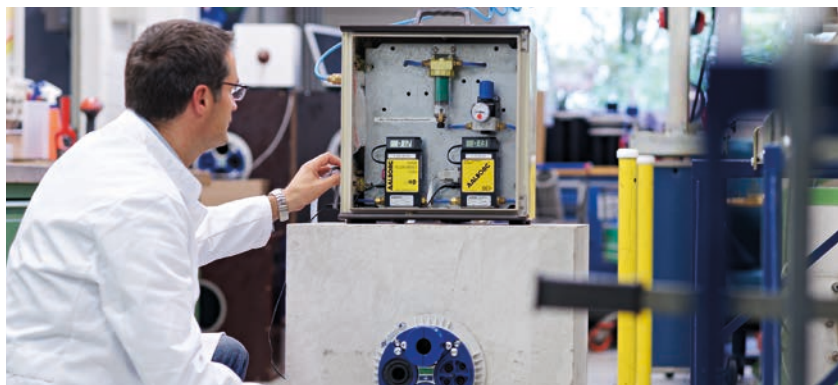
Dichtigkeitsprüfung von Gewerken einer Mehrsparten-Hauseinführung
