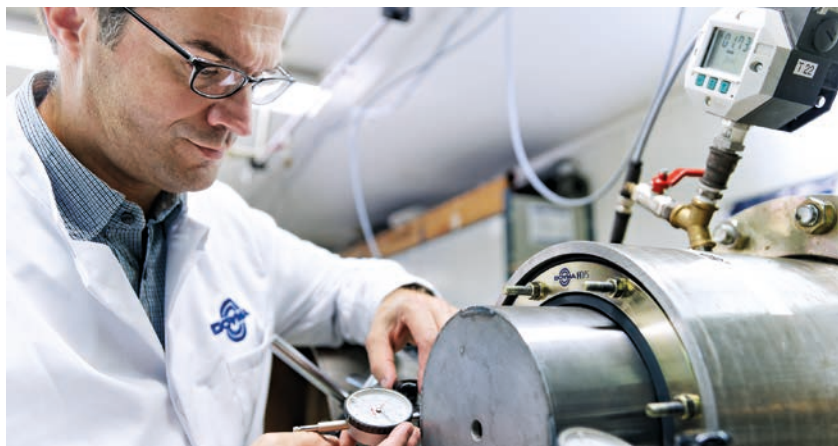
Rutschgrenzen-Test bei einem Dichtungseinsatz
