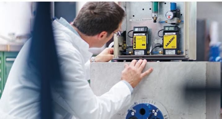
Dichtigkeitsprüfung an einer Mehrsparten-Hauseinführung
