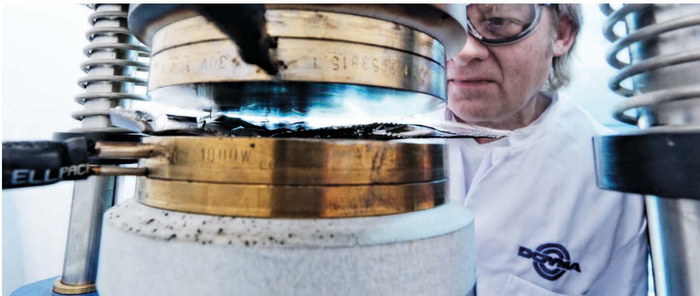
Blähddruckmessung an intumeszierendem Material
